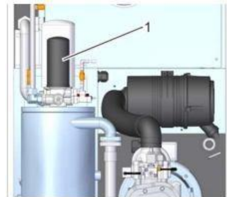
Рис. 13: Масляный фильтр очистки масла
