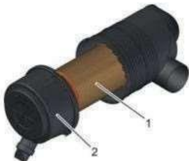
Рис. 42: Разборка корпуса воздушного фильтра
