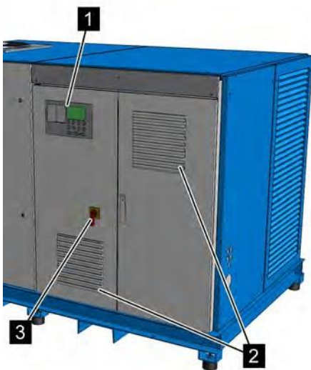
Рис. 11: Элементы управления и фильтр распределительного шкафа
