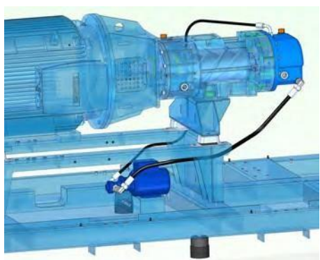
Рис. 16: Насос для смазки редуктора ступени компрессора
