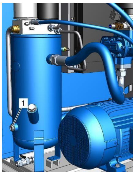
Рис. 32: Проверка уровня охлаждающей жидкости через смотровое отверстие
