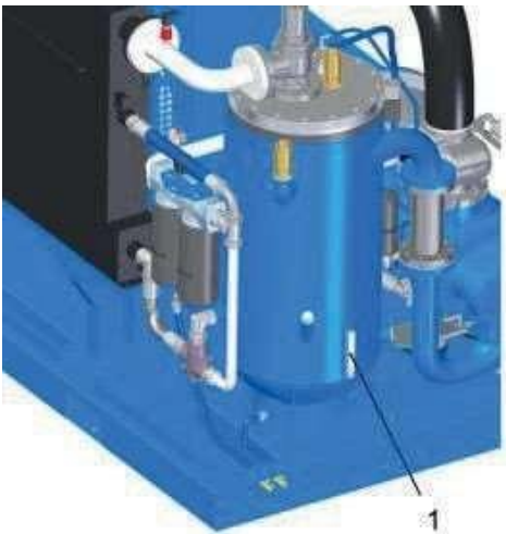
Рис. 36: Проверка уровня компрессорного масла через смотровое стекло
